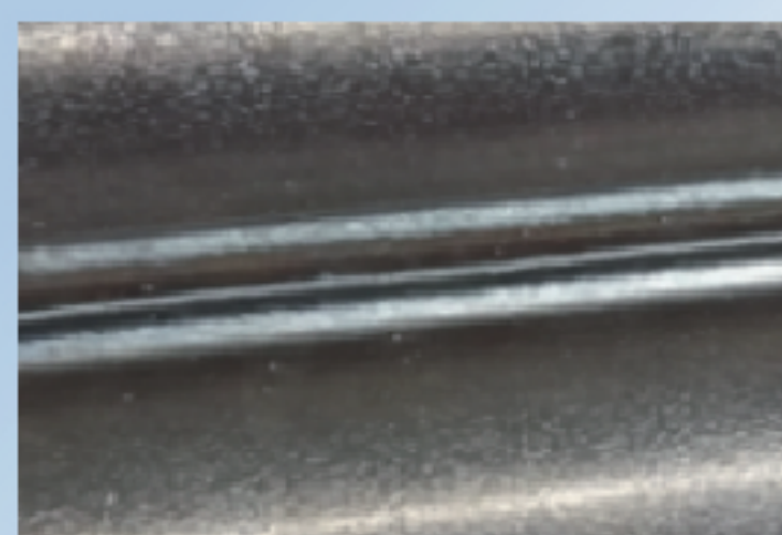
管屏壁焊接应用 案例③ 母材: T91 焊丝: ER90S-B9 \phi 1.2
