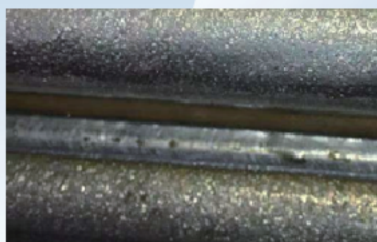
管屏壁焊接应用 案例① 母材: 15CrMo 焊丝: ER50-B2 \phi 1.2
