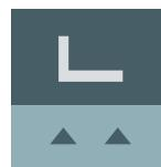
**L 标记**形似 L，方便机器人以不同的方式和方向停靠。机器人可以停靠在 L 标记的内侧和外侧。这种标记可以在机器人的任一侧。我们建议机器人停靠时与 L 的较长边平行。
