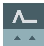
**VL 标记**比 V 标记大一些，能让机器人的停靠更准确。它由一个右侧带有挡板的 V 形标记组成。与 V 标记一样，VL 标记专为机器人停靠而设计，因此机器人前后都可以对接该标记。为确保精确停靠，充电站的形状像 VL 标记。
