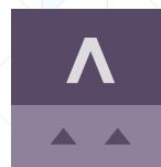
**V 标记**是机器人可用的最简单的标记。它由一个带有内角的 V 形组成。机器人必须直线停靠至 V 标记。
